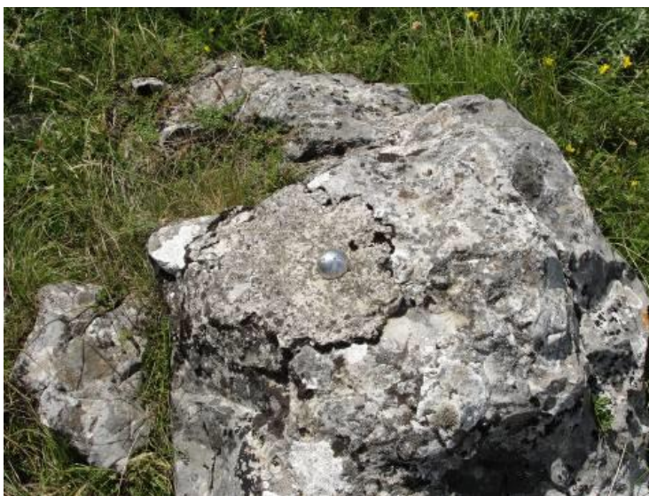
Slika 3: Prikaz stabilizacije točke geodetske osnove
