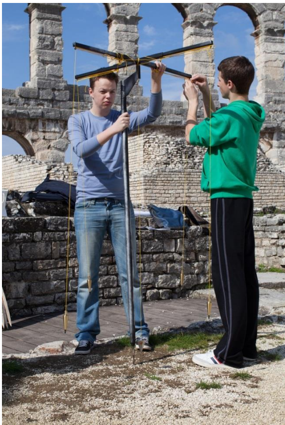
Slika 1: Učenici Tehničke škole Pula s rekonstrukcijom rimske grome u pulskom amfitetaru.
