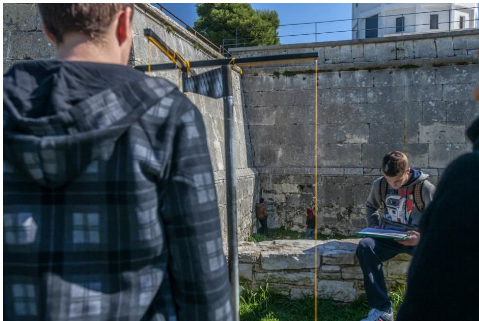
Slika 3: Viziranje nedostupne točke s druge strane kanala na pulskom Kaštelu uz pomoć grome- 1. faza vježbe fluminis varatio.
