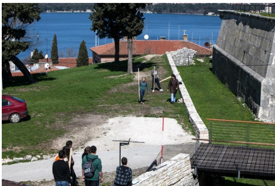
Slika 4: Iskolčenje pravca uz pomoć grome-3. faza vježbe fluminis varatio na pulskom Kaštelu.
