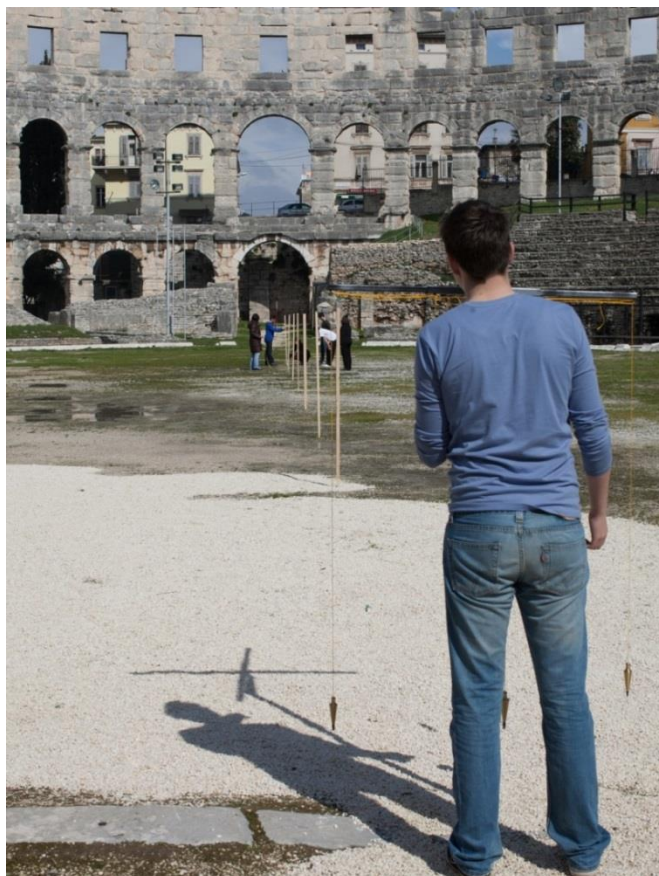
Slika 2: Izmjera velike i male osi borilišta te velike osi amfiteatra uz pomoć grome.
