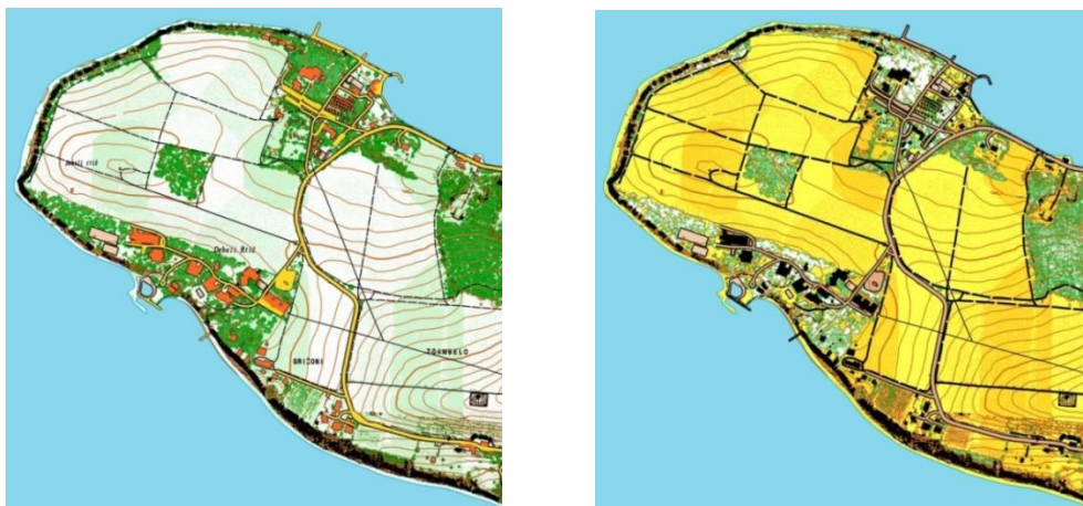
Slika 7: Topografska karta i karta za orijentacijsko trčanje, kreirani na osnovu podataka državne geodetske službe i podataka laserskog skeniranja
